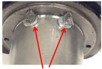
Magnetfilter mit Sieb im Pumpengehäuse -Aufnahme von Schmutz und Spänen - geringerer Verschleiß der Dichtungen
