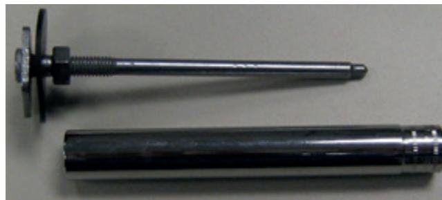
Befestigungsschraube hintere Stoßstange eines Mercedes Benz
