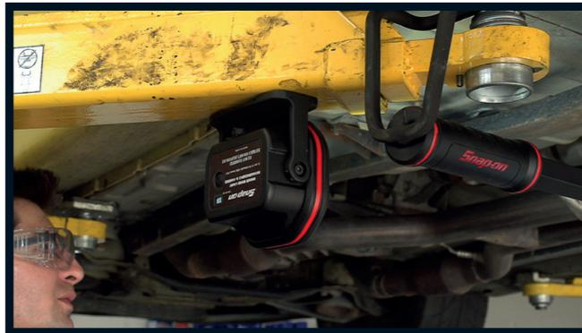
Abnehmbare Lampeneinheit (ECUHA1581AE) mit Magnetfuß bietet zusätzliche Möglichkeiten der Anwendung und gute Ausleuchtung in engen Bereichen
