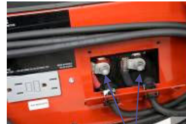
Positives und negatives Batteriekabel können vor Ort gewechselt werden: EEBC500-6 & EEBC500-7
