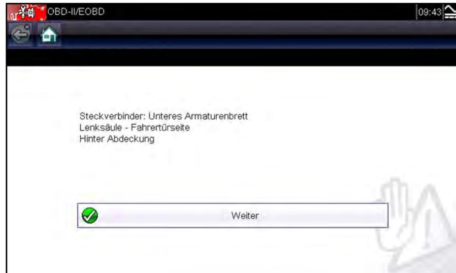
Abbildung 6-4 Beispielposition für den Datenanschluss
