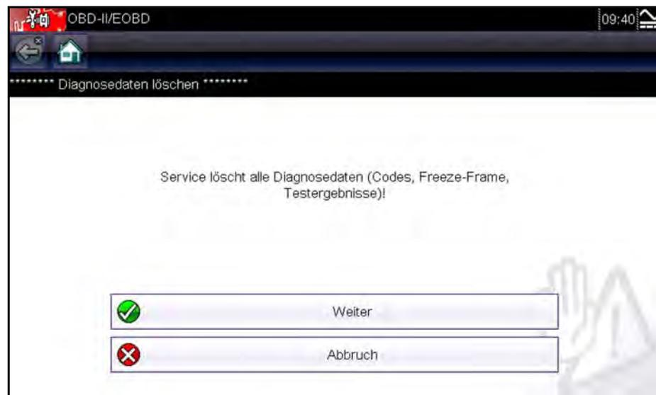
Abbildung 6-7 Beispiel für Bestätigung zum Löschen von Codes
